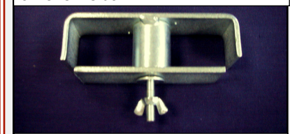
Låsbygel för två sty fyrkantben. Vridblecket ger snabb applicering.
