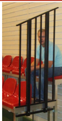
Standard plastlås. Klämmer ihop podieramarna och underlättar och "styr" podierna vid monteringen.
