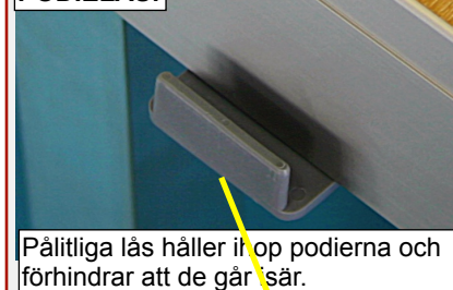
Benlåsen sitter längst ut i podieramens hörn och är så säkra att det inte behövs någon separat stagning förrän vid 1500 mm podiehöjd.
