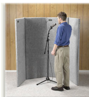
S4-2 och S5-2 SORBERS är fristående bafflar. Absorberar det "irrande" ljudet i studion. Rummet ekar mindre. Varje enhet består av två delar som kopplas samman med ett tyggångjärn. Användes som absorberent i de flesta IsoPacs. Flera S4-2 och S5-2 SORBER set kan kopplas ihop med kardborreband.
